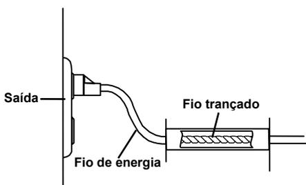
Fios elétricos redondos que contêm um condutor trançado interiormente farão com que o AC Sensor acenda, deixe de acender, então acenda novamente conforme a ponta é movimentada ao longo do comprimento do fio. Isto é devido ao fio condutor produzir voltagem. (Figura 3)
