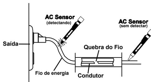
Quando você move a ponta de plástico longe da origem elétrica (neste caso a caixa de energia presa na parede), a ponta parará de acender no ponto exato da quebra do fio. (Figura 2)
