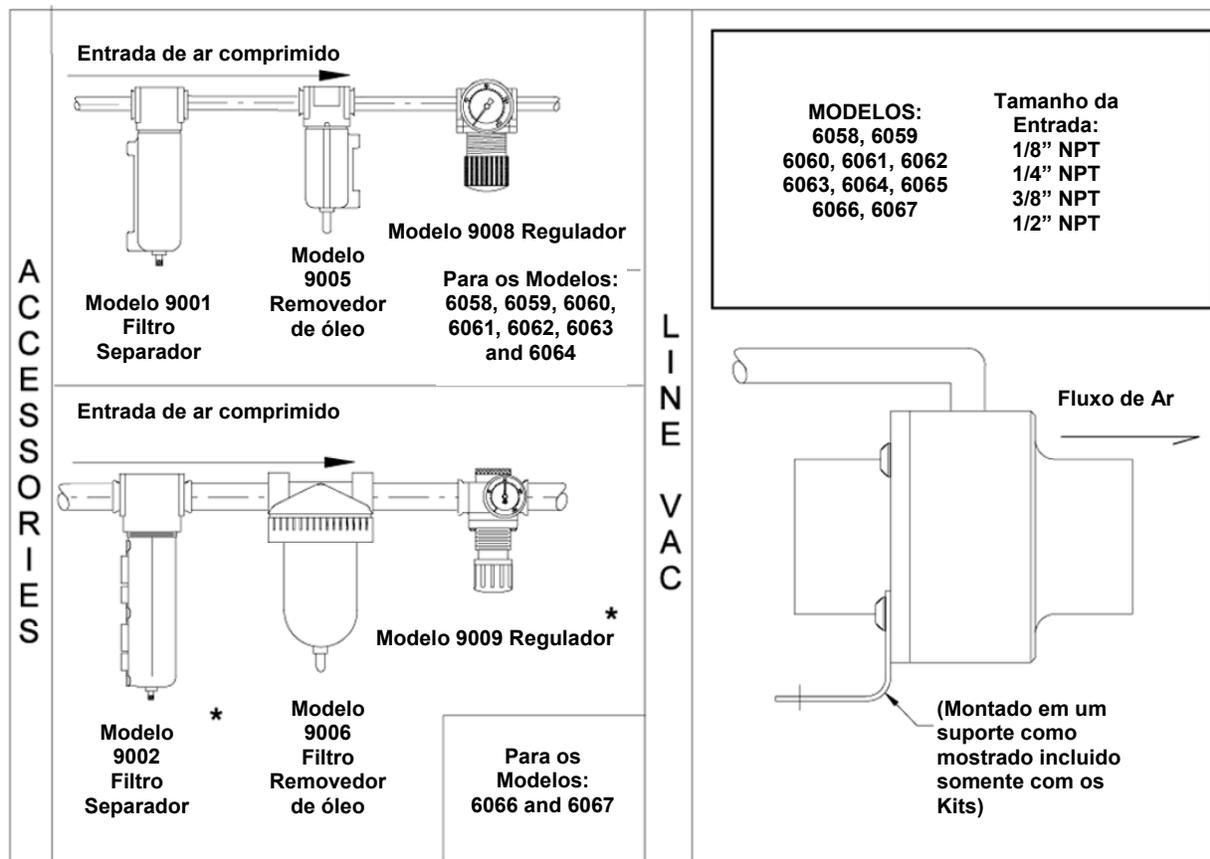
\*Para o Modelo 6065 – Use o Filtro Separador Modelo 9032 e o Regulador de Pressão Modelo 9033
