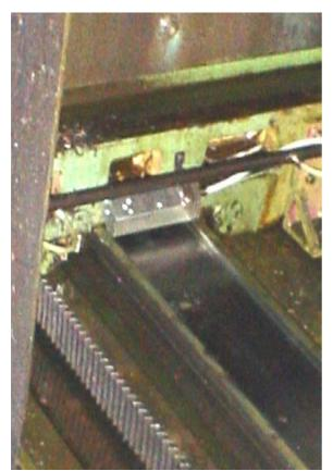
Seis Super Facas de Ar EXAIR Modelo BP110006 foram instaladas no carro da máquina (três de cada lado) sobre a área de deslizamento e sobre as guias. As Super Facas de Ar cobriram completamente os seis modos de transporte, com uma lâmina de ar uniforme de alta velocidade, sendo os fragmentos soprados assim que o carro da máquina fosse movido.
