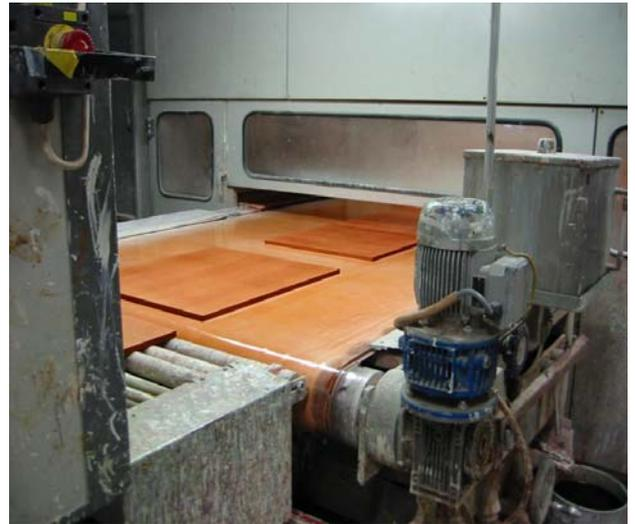
**Solução #2:** Uma Super Faca de Ar Modelo 110048 removeu o pó do lixamento, antes da pintura.
